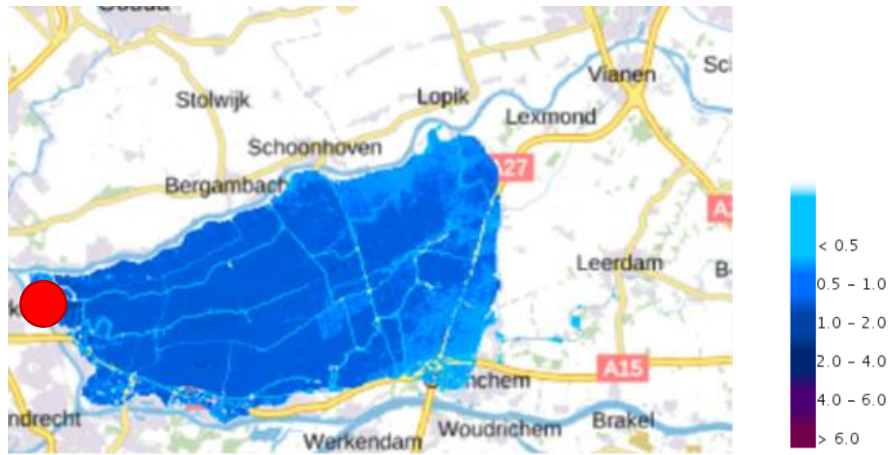
Figuur 3.3 Voorbeeld scenario overstrooming door stormvloed op zee, doorbraaklocatie Kinderdijk (rode stip op kaart) (bron: LIWO)
